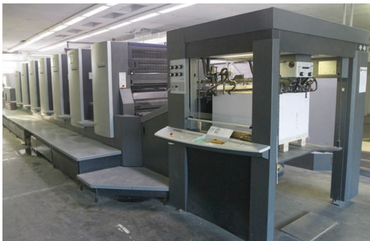
První liga v polygrafii. Heidelberg Speedmaster CD 102-6+L zvládá nejen velkoformátový tisk – má i obracíací zařízení pro oboustranný tisk či možnost tisku a efektně lakování jedním průchodem strojem.
