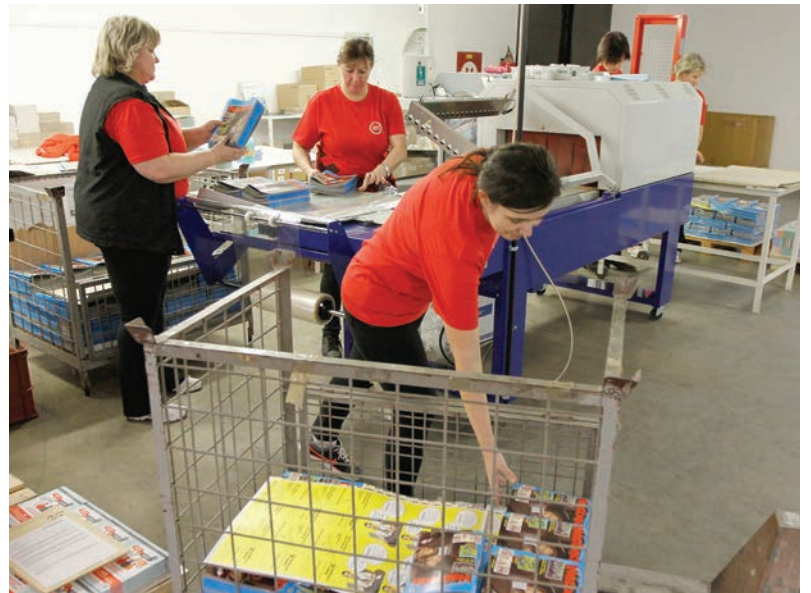
Balení. Poloautomatický tunelový balicí stroj Espert 7555 je pomocníkem pracovník při balení tiskovin do smrštitelné fólie.
