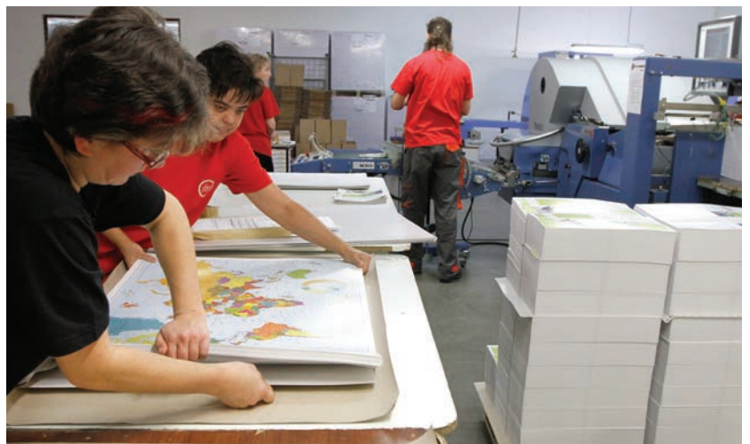
Symbióza práce lidí a strojů. Skládačka papíru Heidelberg Stahlfolder TD 112 Topline dokáže jako jedna z mála v kraji skládat mapy a letáky. Mapy-postery zase balí pracovníce s největší opatrností tak, aby se nepřehnul ani rožek.
